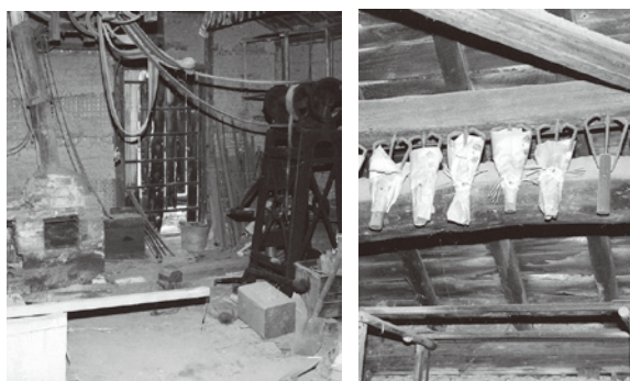
木下鍛冶屋(築城)の内部と梁に飾られたお飾りもん 左に煉瓦積の鍛冶炉があり、その奥に鞆(送風機)の置場があった。近年は電動式送風機で送風し、鉄素材を加熱し、右のベルトハンマーで鍛打した。(平成14年廃業)
