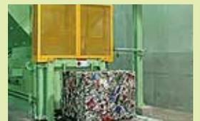
缶類系選別機でスチールとアルミに分けられブロック状に固められます
