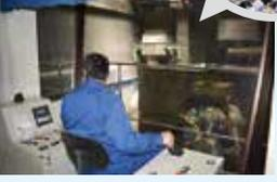
クレーンを操作し、ごみ固形燃料化プラントへ。
