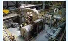
プラント内で、破碎→乾燥→磁選→成形→製品サイロの工程を経て処理されます。
