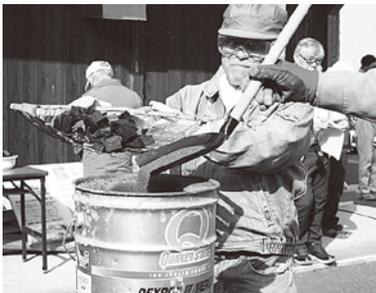
▲④炉に木炭と砂鉄を投入
